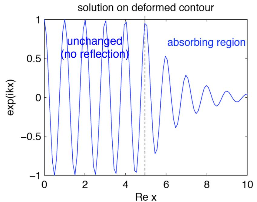
$$\text{fields} \sim f(y, z) e^{i(kx - \omega t)} \rightarrow f(y, z) e^{i(kx - \omega t) - \frac{k}{\omega} \sigma x}$$
